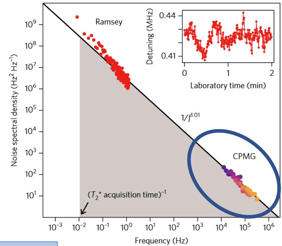
$$S\left(\frac{n}{2 \cdot t_{\text{wait}}}\right) = -\ln(A_{\text{CPMG}})/2\pi^2 t_{\text{wait}}$$
